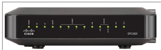
Eén van de modellen DOCSIS gateway voor thuisgebruik (DPC3925 of EPC3925):
